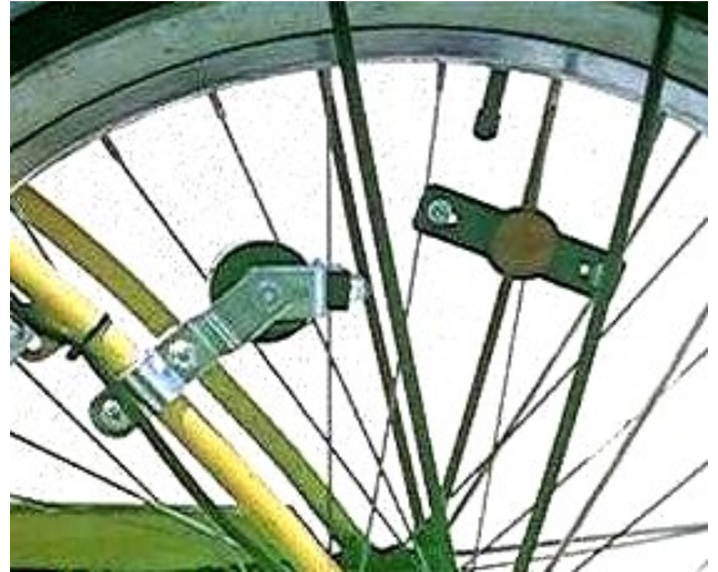
A mágnes és a prizma néhány csavar meghúzásával rögzíthető a vázhoz és a küllőkhöz
